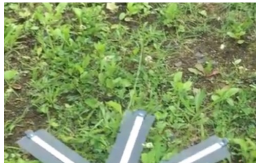
図 2: 能代宇宙イベント出場機体。みかんの皮のような形で紐との絡まりを避ける。
